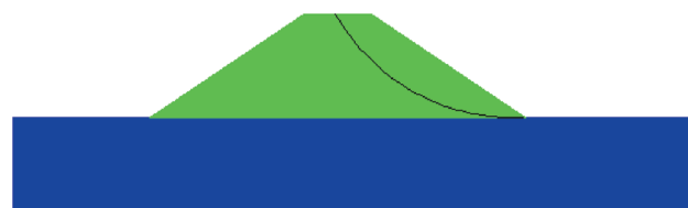
Рис. 3. Расчет минимального коэффициента устойчивости
