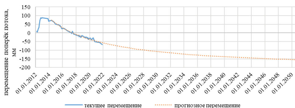
Рис. 8. График прогнозных горизонтальных смещений поперек потока марок, установленных на берме низовой упорной призмы, на период до 2050 г.
