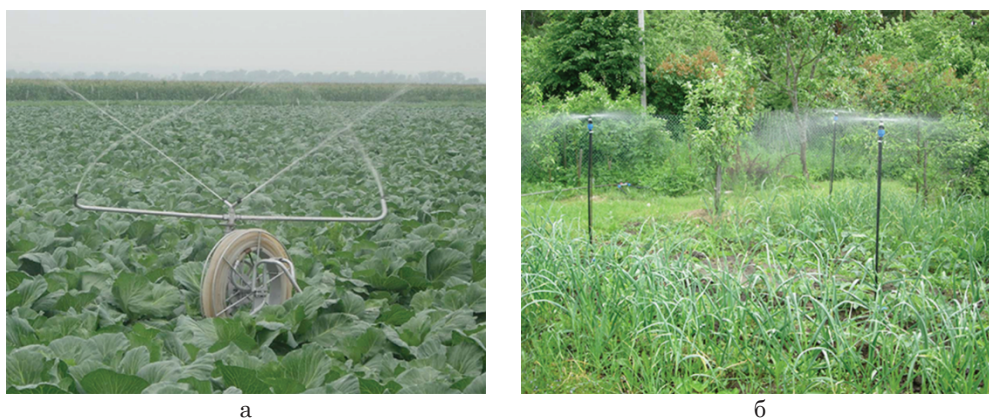
Рис. 1. Общий вид дождевальных установок для полива кассетной рассады: а – дождевальная установка ДШ-1; б – ДУ «Россинка»
