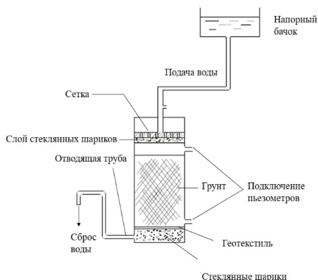
Рис. 2. Схема загрузки и подключения фильтрационных приборов
