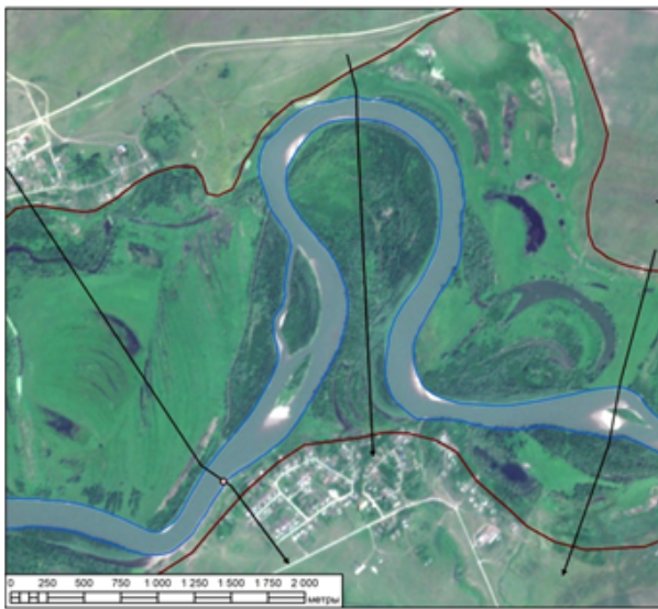
Рис. 1. Река Чарыш на участке Белоглазово – Усть-Калманка и ее представление в одномерной (1D) компьютерной модели гидродинамики руслового потока:
