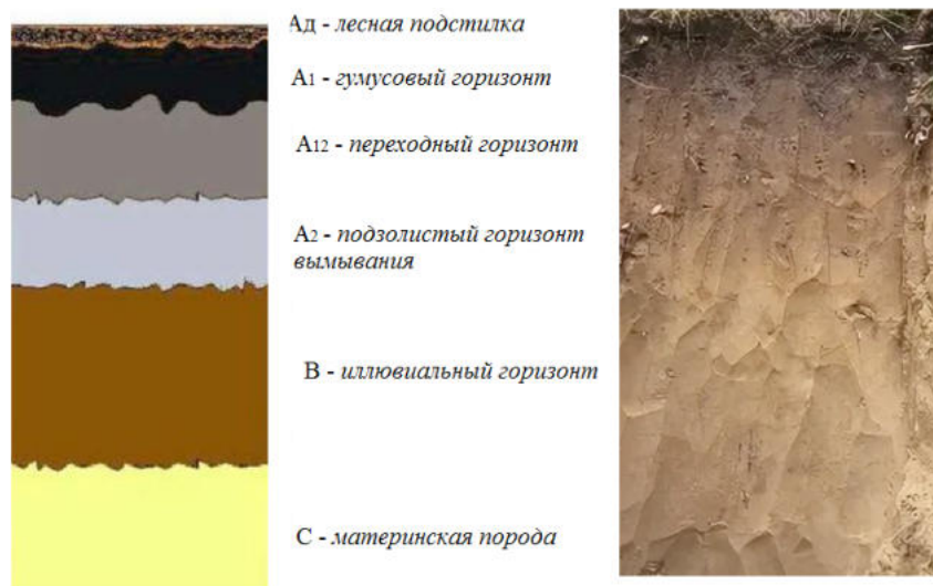
Рис. 2. Схема почвенного профиля и внешний вид горизонтов дерново-подзолистой почвы
