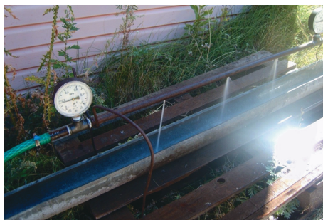
Рис. 2. Уточнения коэффициента отсоединения жидкости a_2 Fig. 2. Clarification of the coefficient of disconnection of the fluid a_2
