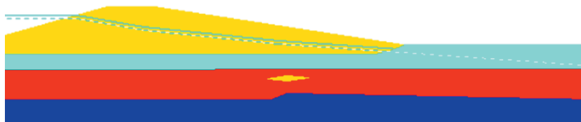
Рис. 5. Результаты ввода грунтов для второго расчетного случая в расчетном сечении ограждающей плотины Краснодарского водохранилища в долине р. Псекупс
