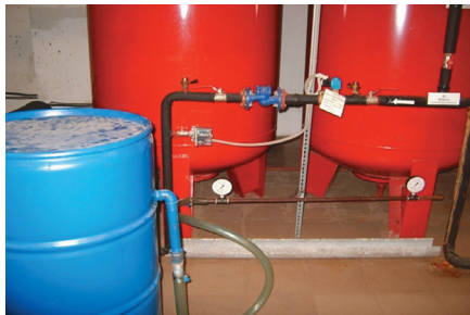
Рис. 1. Лабораторная установка для определения характеристик потока Fig. 1. Laboratory installation for determining the characteristics of the flow
