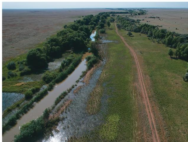
**Рис. 4. Места перелива воды через гребень канала**
