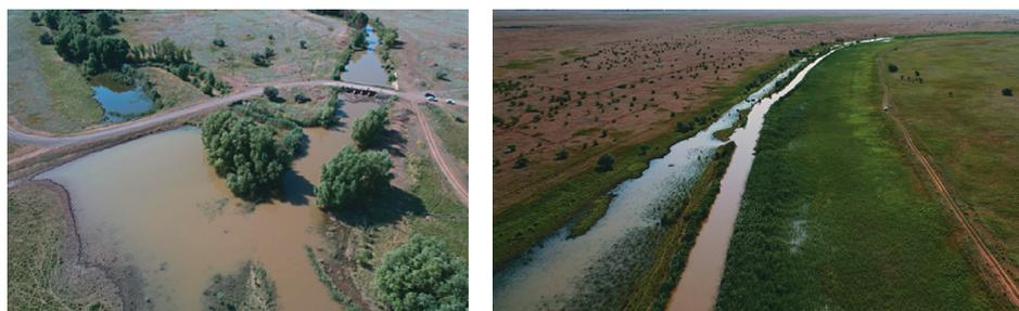
Рис. 2. Разрушение дамбы канала и подтопление приканальных территорий на МК ВР-1 СООС (фото предоставлено ФГБУ «Управление «Калммелиоводхоз»)
