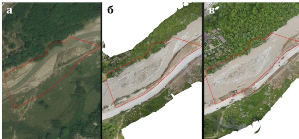
Рис. 1. Участок разрушения объездной автодороги селевым потоком:
