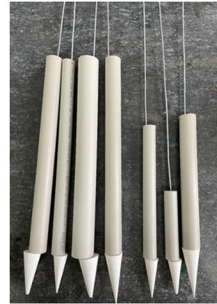
Рис. 3. Модели комбинированных анкеров с коническим наконечником
