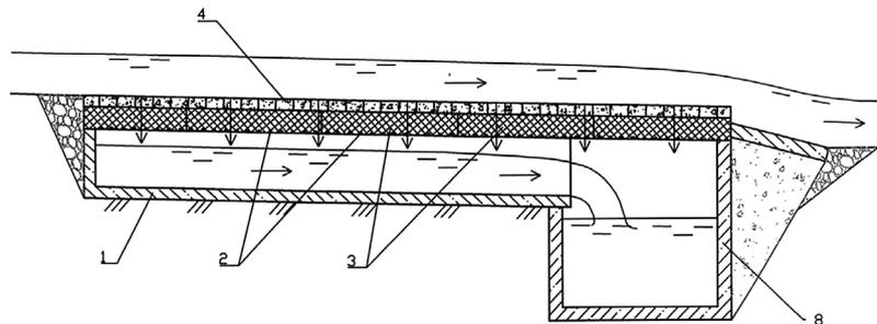
Рис. 4. Подруловый водозабор комбинированной конструкции.
