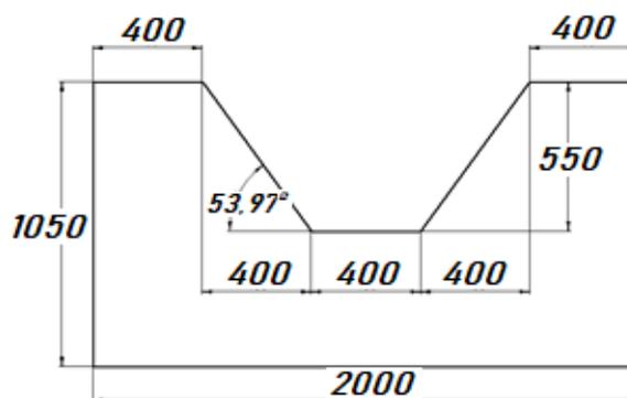
Рис. 1. Общий вид и размеры канала в поперечном сечении
