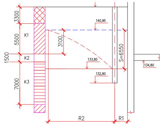
Рис. 3. Схема к расчету однолинейного вертикального дренажа несовершенного типа
