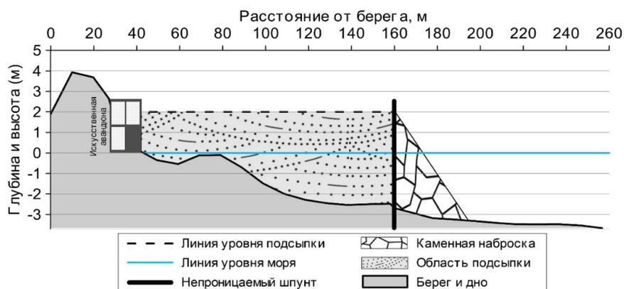
Рис. 4. Схематичный разрез области подсыпки планируемого берегозащитного сооружения
