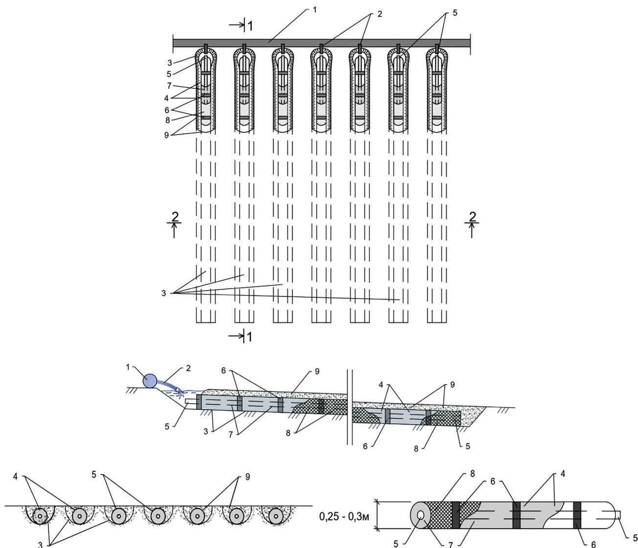
Рис. 3. Противоэрозионная мелиоративная система поверхностного полива по бороздам.
