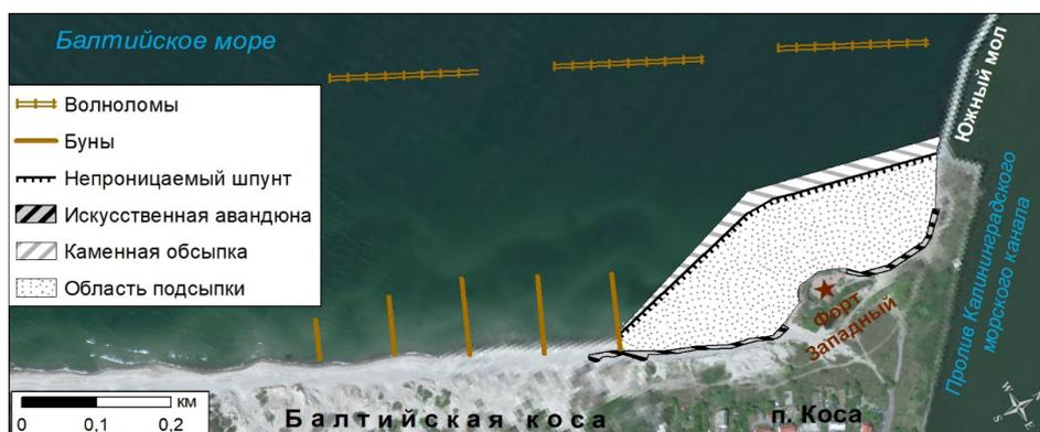
Рис. 2. Схема планируемого берегоукрепления (источник – ГБУ КО «Балтберегозащита»)
