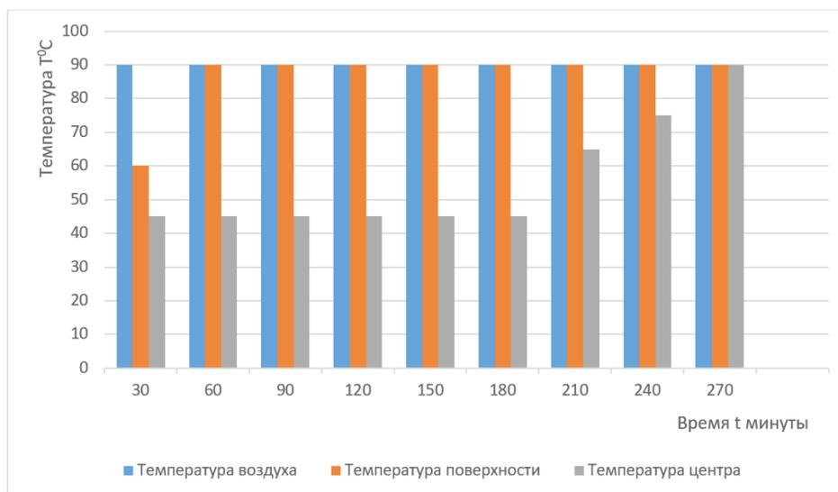
Рис. 7. Достижение образца торфа В параметров самовозгорания
