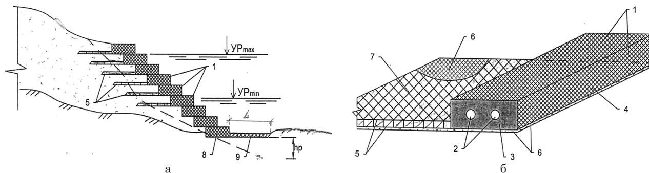
Рис. 2. Укрепление мелиоративного канала армогрунтовой конструкцией, патент № 2801714, 2023 г. [11]:
