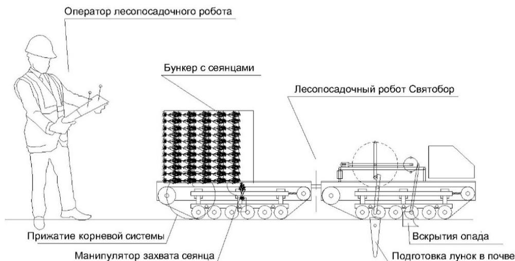
Рис. 4. Схема посадки лесных культур с помощью робота
