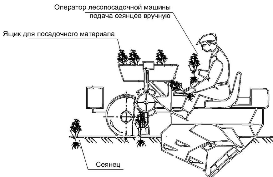
Рис. 1. Схема посадки лесных культур лесопосадочной машиной
