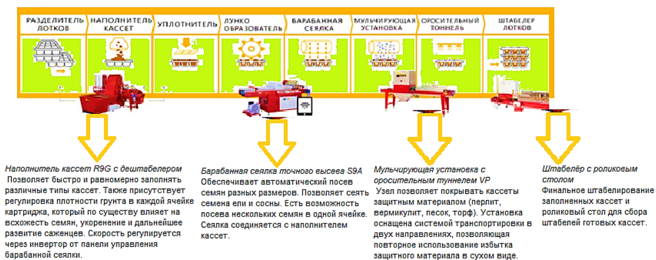
Рис. 5. Основные элементы линии высева семян в кассеты «Mosa green»
