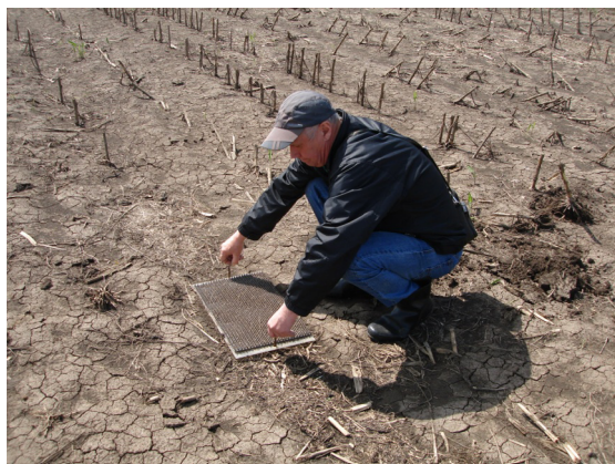
Рис. 2. Снятие седиментационных ловушек на опытном участке после прохождения весеннего половодья
