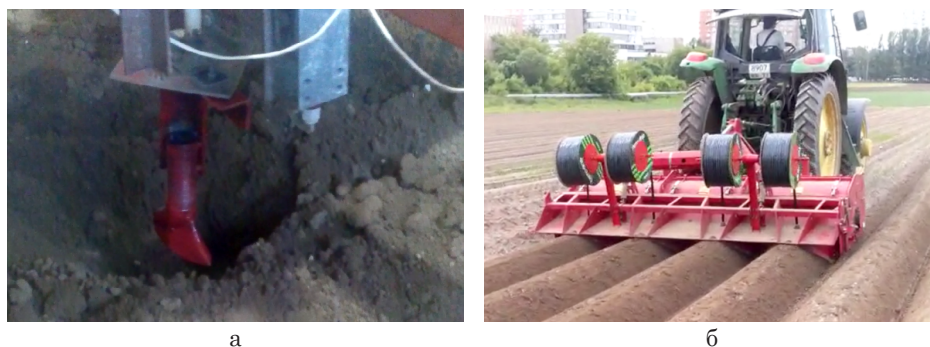
Рис. 2. Испытания рабочего органа укладчика в лаборатории (а) и на базе формирователя картофельных гребней Grimme GF-75/4 (б) на Полевой опытной станции РГАУ-МСХА имени К.А. Тимирязева
