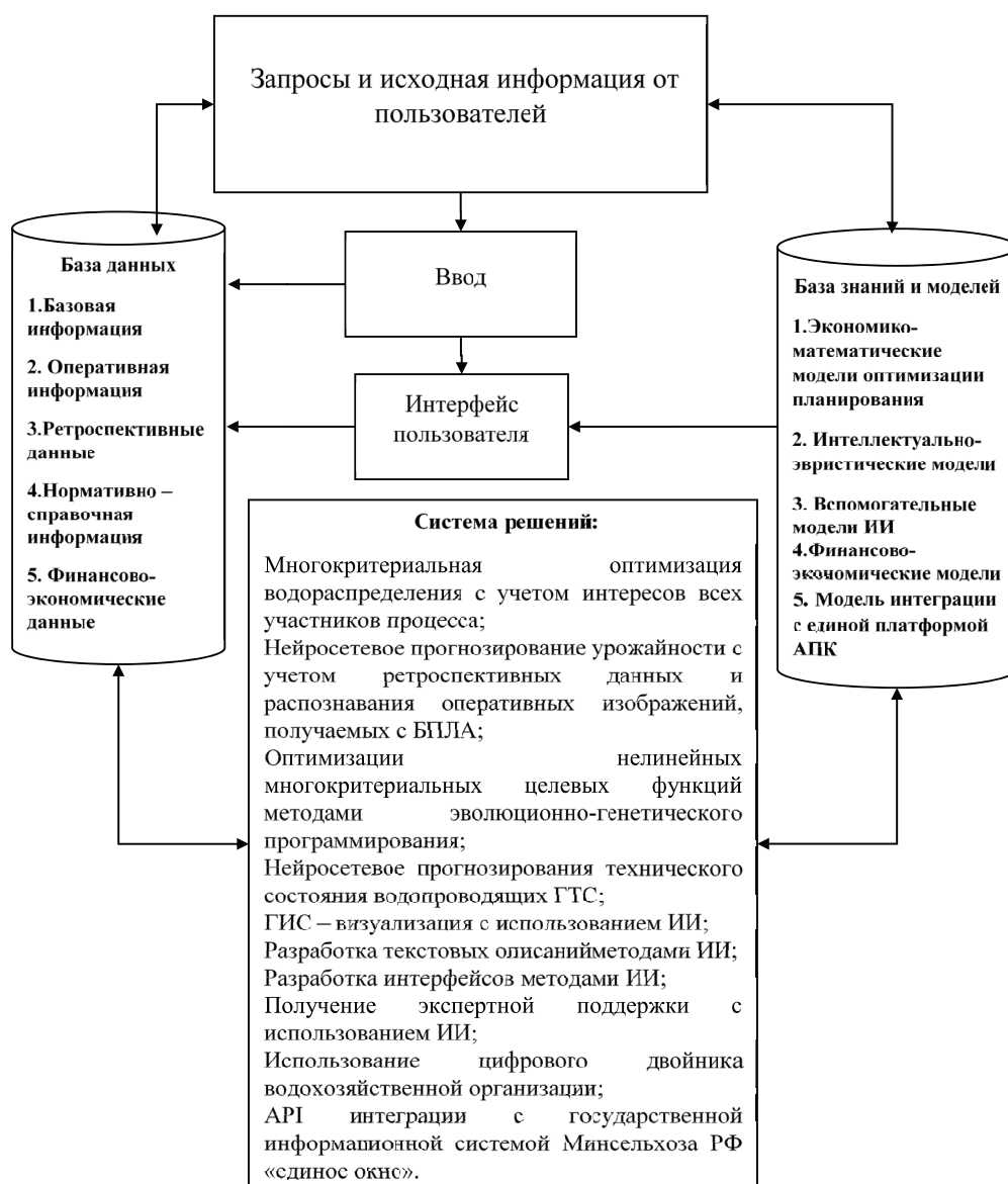
Рис. 1. Фрагмент функционального прототипа АСУ Водопользование ОС»
