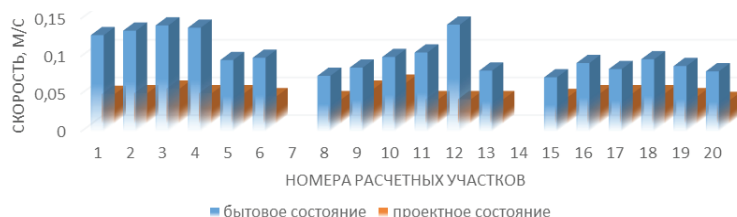
Рис. 7. Динамика изменения скоростей потока до разработки карьера и после нее Fig. 7. Dynamics of changes in flow rates before and after quarry development
