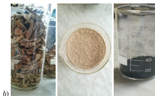
Рис. 5. Алгоритм получения из зеленой массы борщевика Сосновского биопродуктов: а – алгоритм; б – гранулы, порошок, топливо
