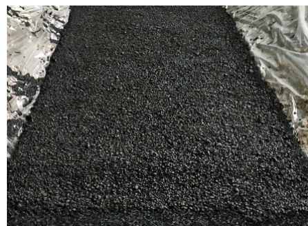
Рис. 4. Противоэрозионный материал – геомат марки Энкамат А20, заполненный щебнем и битум-полимером (фото авторов)
